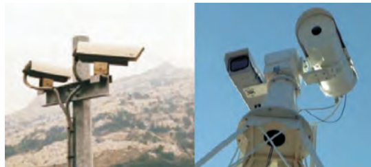
Fig. 7 - Câmaras com sistemas de detecção automática de incêndios florestais
