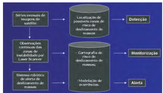
Fig. 6 - Diagrama de aplicação do módulo de movimentação de massas. Fonte: SRPC, IP-RAM.
