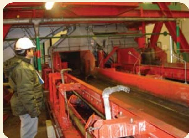
Figura 5 a – Transporte das escórias para o edifício de separação dos ferrosos
