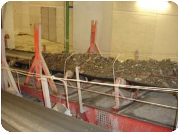
Figura 5 b – Transporte das escórias para o edifício de separação dos ferrosos
